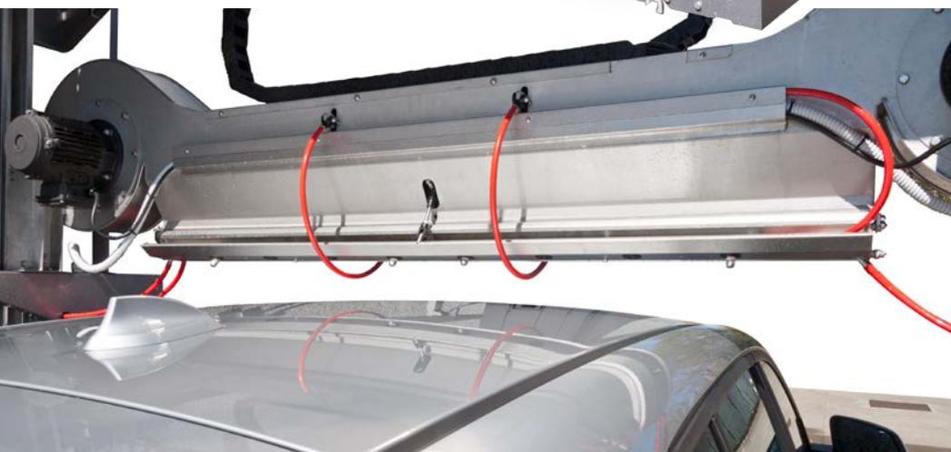
L'ALTA PRESSIONE DEL PULSE HP può lavorare sia singolarmente sia in abbinamento con detersivi chimici. Per migliorare notevolmente la loro azione, durante la fase di prelavaggio, vengono riscaldati. A tale scopo, il PULSE HP utilizza un dispositivo riscaldatore a flusso continuo con regolazione elettronica della temperatura.
